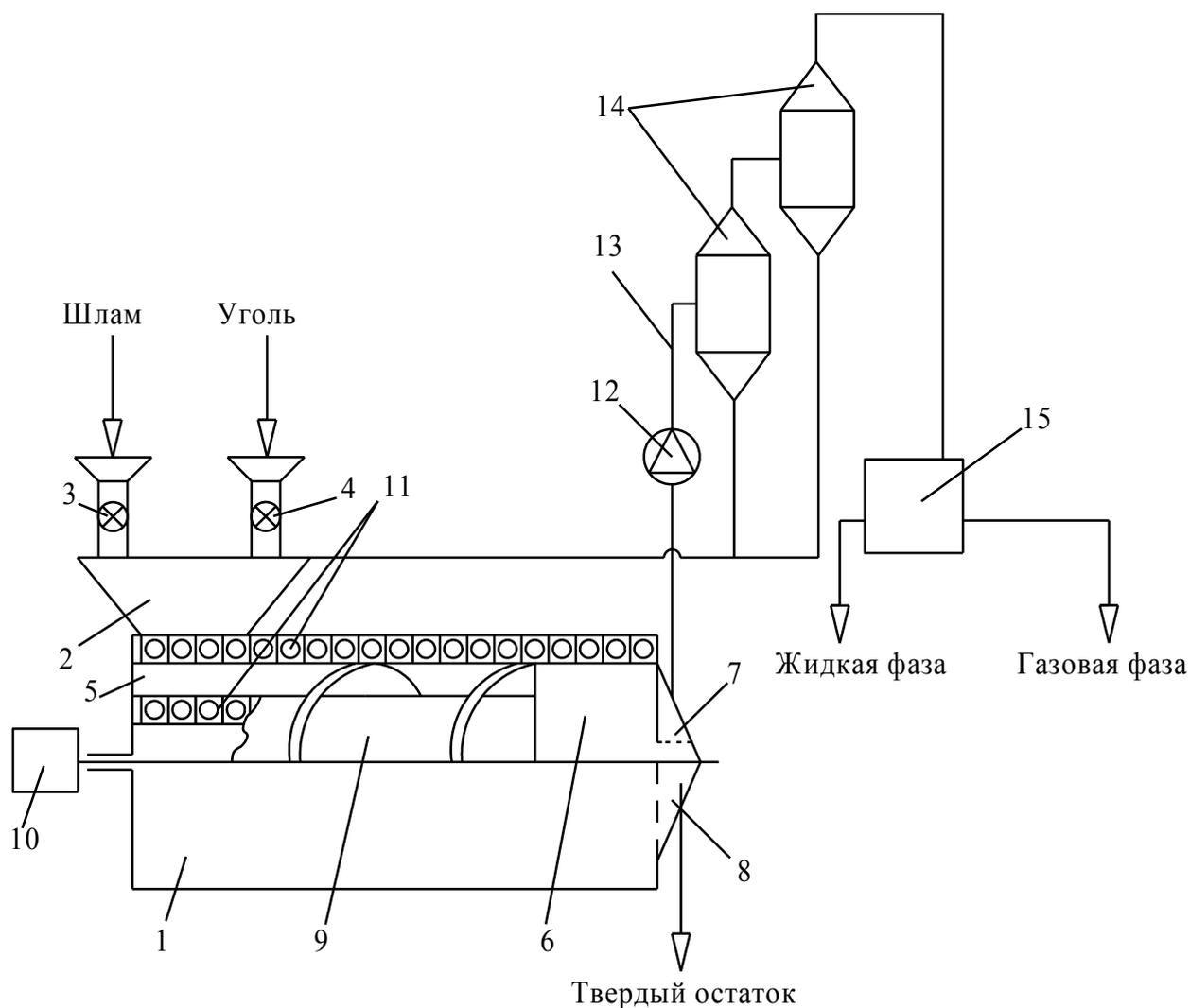
1 – корпус реактора, 2 – загрузочное устройство, 3,4 – дозаторы, 5 – транспортная камера, 6 – реакционная камера, 7 – газовая камера, 8 – поворотный люк, 9 – шнек, 10 – двигатель, 11 – термические блоки, 12 – насос, 13 – газовая магистраль, 14 – циклоны, 15 – камера охлаждения, 16 – магистраль для отвода твердых примесей
